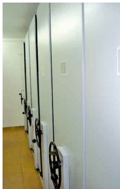
En el nou dipòsit que acull la documentació audiovisual s'han instal·lat armaris de tipus compactus que permeten conservar adequadament les pel·lícules, fotografies, cintes...
