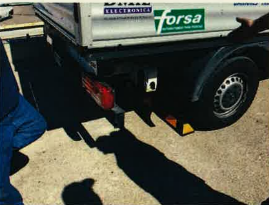
Foto 5: Amidaments per col·locar un topall al voltant dels contenidors per evitar que els vehicles s'acostin massa al límit del moll de descàrrega.
