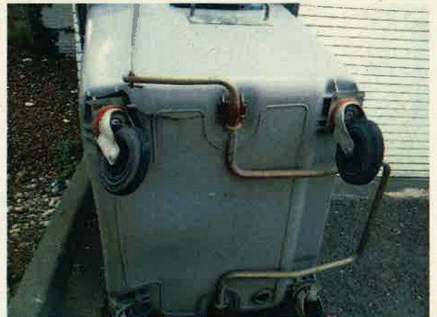
FOTOS 15 i 16: Nova fixació col·locada al contenidor del carrer Rector Felip i Gibert i roda trencada del contenidor de l'IES Coll i Rodés pel pes de la runa ficada dins.
