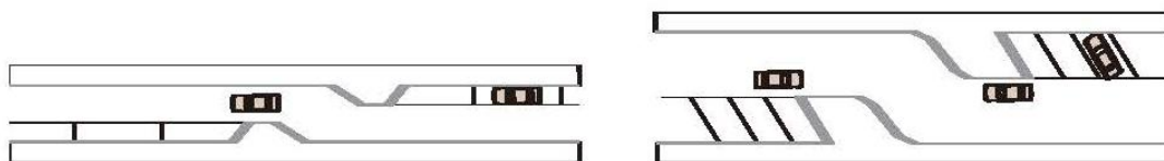
Imatge 18. Diverses possibilitats de combinació de places d'aparcament amb desplaçament de l'eix de la trajectòria
