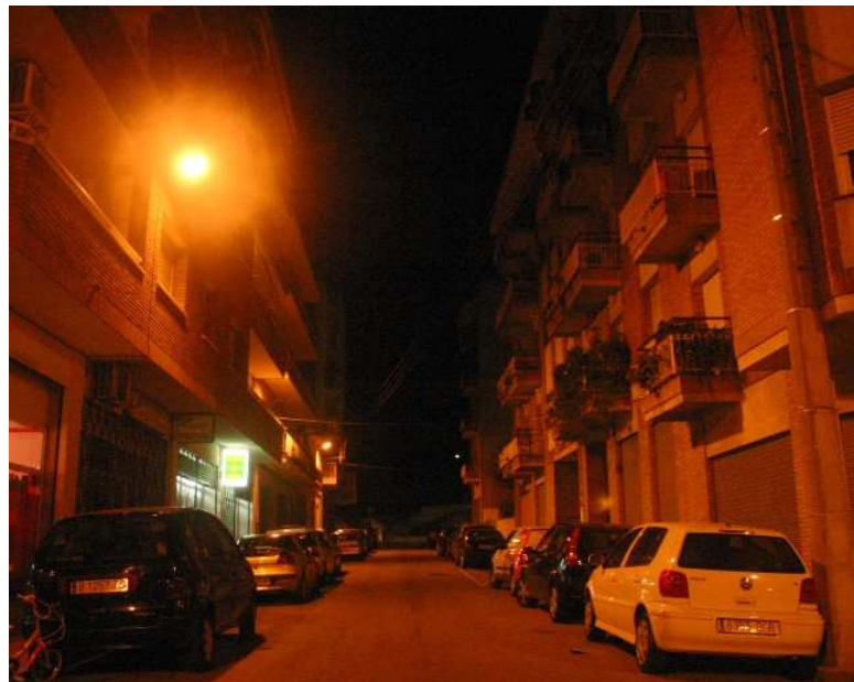
Exemple d'il·luminació amb làmpada de vapor de sodi a alta pressió
